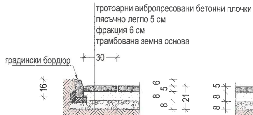
НАСТИЛКА БЕТОННИ ПЛОЧИ М 1:20
