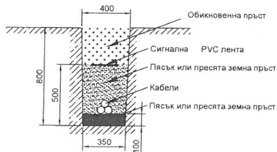
Полагане на кабели в изкоп непосредствено в земята
